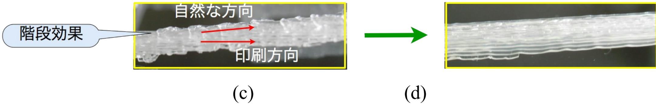
これに対して，ここで提案する「自然な方向にそった 3D 印刷」の方法（「A Method of 3D Printing which is Consistent with Natural Direction in Shape」[http://www.kanadas.com/papers/2013/08/a\\_method\\_of\\_3d\\_printing\\_which.html](http://www.kanadas.com/papers/2013/08/a_method_of_3d_printing_which.html) 参照）ではつくるべきものがもつ「自然な方向」（下図参照）にそって，つねに印刷ヘッドを上下にうごかしながら印刷する（上図 (b) 参照）．その結果，上図 (d) のようになめらかなかたちが実現される．
