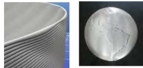
(c) 断面積変化 (modulation) による模様の生成
